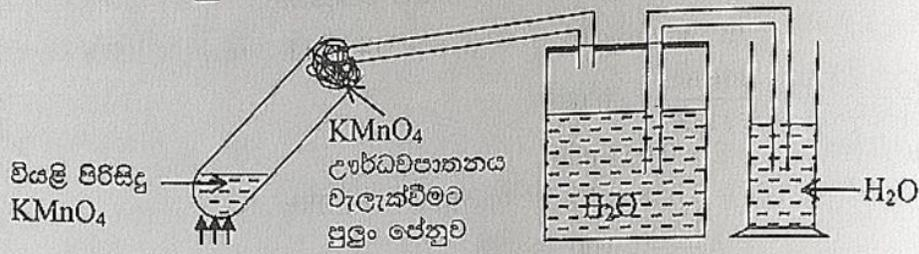
වියලි පිරිසිදු කැකුරුම් නලයකට වියලි පිරිසිදු  $\text{KMnO}_4$  දමා රූපයේ ආකාරයට පුදුම පේත්‍ර කඩ ස්කන්ධය මැන ගනී. ( $w_1$ ) ඉන්පසු එය වික වේලාවක් රත් කර නිවුණු පසු ජල මින සමාන කර පුදුම පේත්‍රව සහිත කැකුරුම් නලය ස්කන්ධය ( $w_2$ ) මැන ගනී. ඉන්පසු ක උෂ්ණත්වය ද ( $T_1$ ) එම උෂ්ණත්වයේ දී සංතෘප්ත ජල වාෂ්ප පීඩනය ( $P_0$ ) ද බලා ගනී. එ ධාහිර වායුගෝලීය පීඩනය  $P_1$  ද බලා ගනී. ඉන්පසු මිනුම් සරාවේ ඇති ජල පරිමාව  $V_1$  මැන
